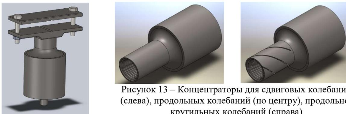
Рисунок 13 – Концентраторы для сдвиговых колебаний (слева), продольных колебаний (по центру), продольно-крутильных колебаний (справа)
